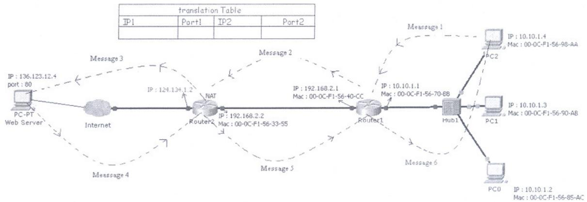
Supposons que la machine PC2 veut envoyer une requête HTTP au serveur web (136.123.12.4), le navigateur utilise le port 1234, le serveur web répond avec une réponse HTTP à PC2.
